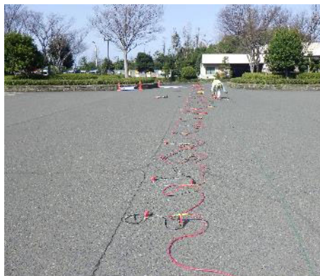
探査測線配置事例
